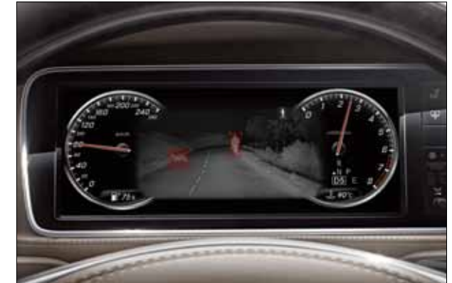
Gece görüş yardımcısı Plus, algılanan kişileri görsel olarak öne çıkarır ve karanlıkta tehlikelere daha hızlı tepki vermesi için sürücüye destek olur.
