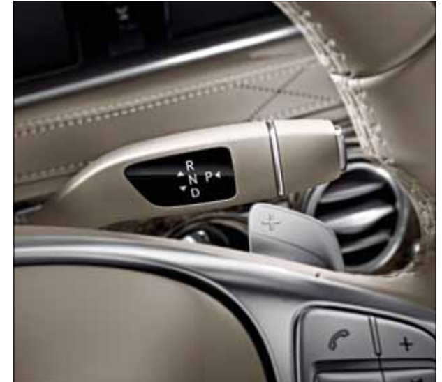
Direksiyon simidinde DIRECT SELECT vites seçme kolu. İlave vites değiştirme düğmeleri ile sürücü manuel olarak da vites büyütebilir veya küçültebilir.
