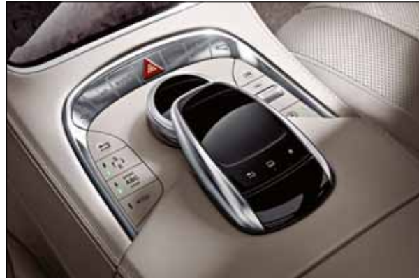
Dokunmatik kumanda paneli, tek veya iki parmakla COMAND Online fonksiyonlarının rahatça kumanda edilmesine izin verir.
