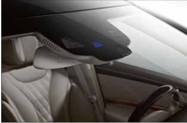
Stereo kamera üzerinden aracın önündeki çevre durumu sürekli olarak algılanır ve değerlendirilir.
